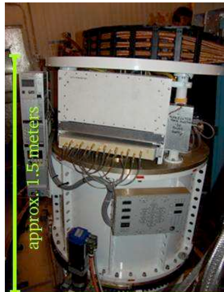
Das Arecibo L-band Feed Array (ALFA) in der Gregorianischen Kuppel. Credit: B. Knispel, AEI Hannover
